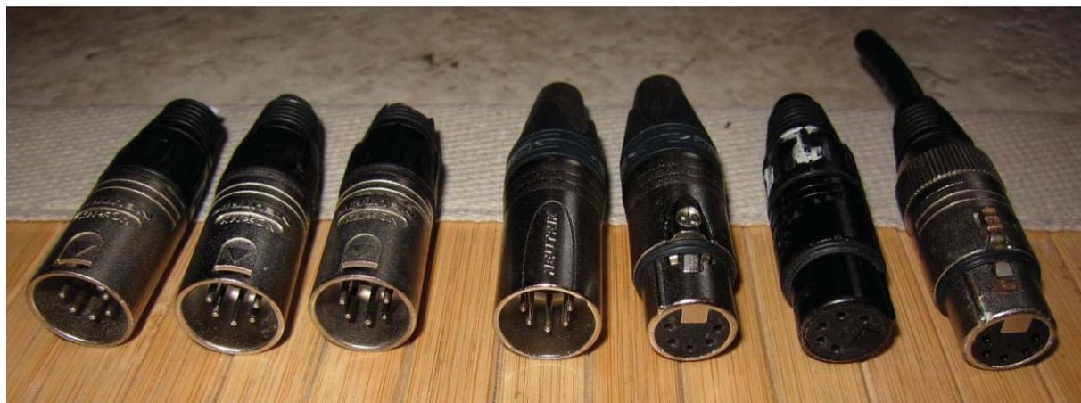
2 x **NC4FX** XLR mit Spannzangen-Zugentlastung für Kabel bis 8,0 mm, € 4,90, Endkappe eingerissen
